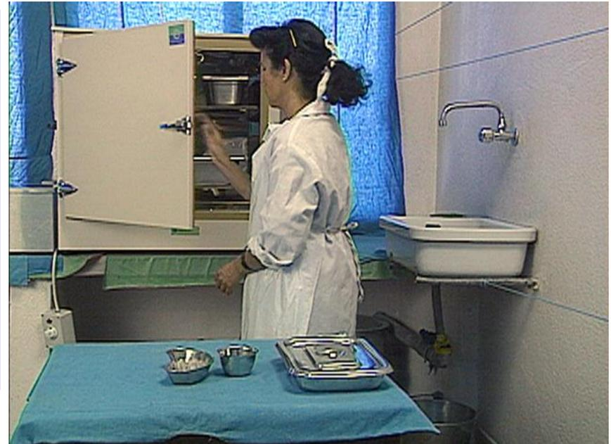
Nota: Dependendo da temperatura seleccionada, o tempo total do ciclo (pré-aquecimento, tempo de esterilização e arrefecimento) variará de 2,5 horas a 170°C, a mais de 8 horas a 121°C.
