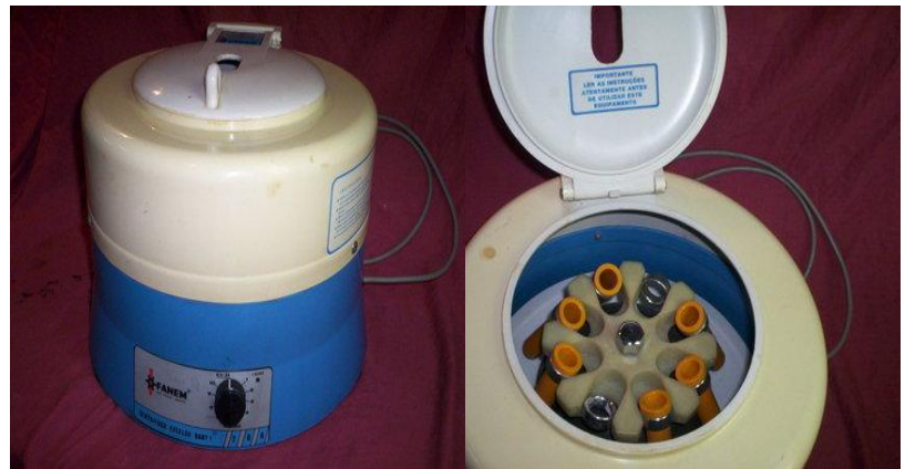
Figura 6: Centrífuga Fanem Macro com 8 tubos
